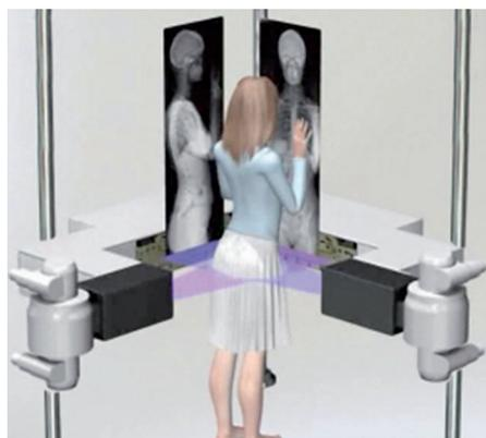
Le système EOS (à g.) de stéréoradiographie à faible dose, développé avec l'aide du Laboratoire a été utilisé pour établir les modèles du rachis
