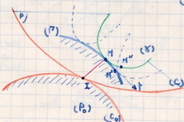
$$R^t \text{ de } P \text{ sur } (\Gamma) = [M^t \text{ de } (M/\gamma)] [R^t (\gamma/P)]$$
