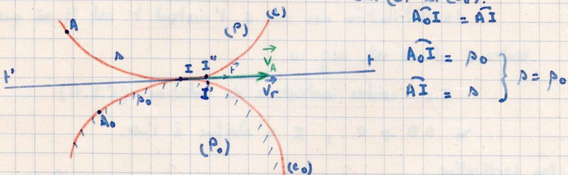
Théorème : dans le m<sup>t</sup> ( $C$ ) / ( $C_0$ ) ou de ( $P$ ) / ( $P_0$ ), le centre instantané de rotation est le point de contact.
