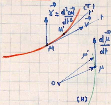
Au mouvement de M sur sa trajectoire correspond le mouvement de  $\mu$  sur l'odographe. Par définition, le vecteur accélération est équivalent à la vitesse de  $\mu$  sur l'odographe.
