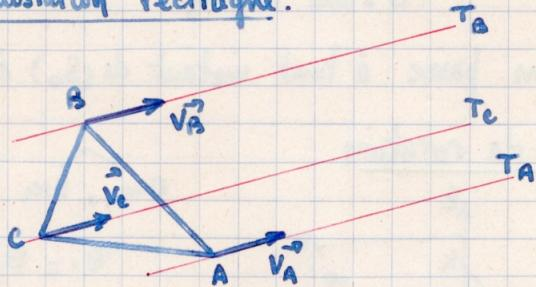
M<sup>t</sup>: tr. rectiligne et uniforme :  $\vec{v} = \vec{v}_0$ .
